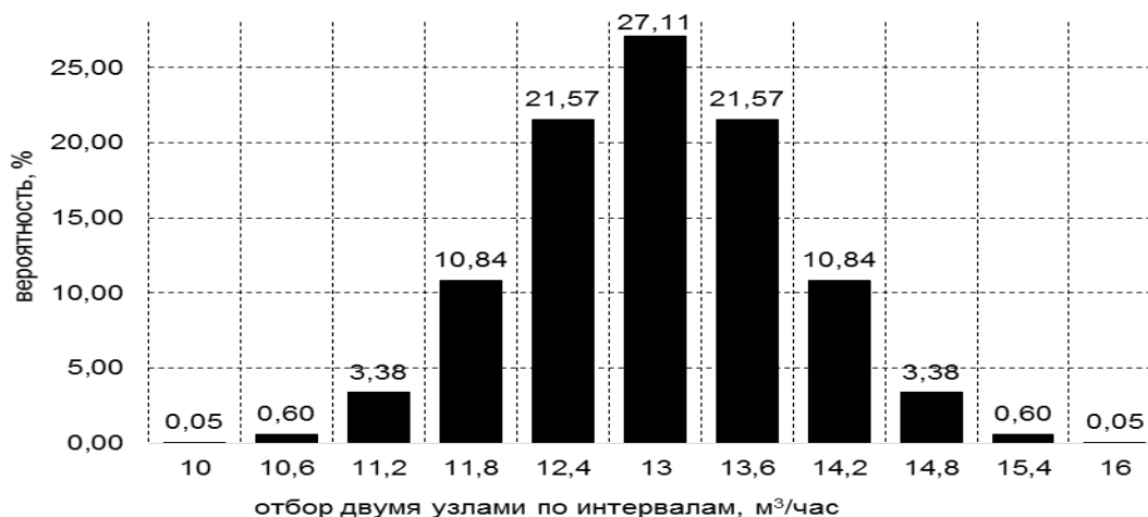
Рис. 4. Гистограмма распределения вероятности отбора воды двумя узлами (по методу комбинаций) Fig. 4. Histogram of the distribution of the probability of water withdrawal by two nodes (according to the method of combinations)
