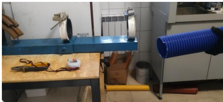
Рис. 2. Общий вид лабораторной установки для определения гибкости шлангов Fig. 2. General view of the laboratory test set for determining flexibility of hoses
