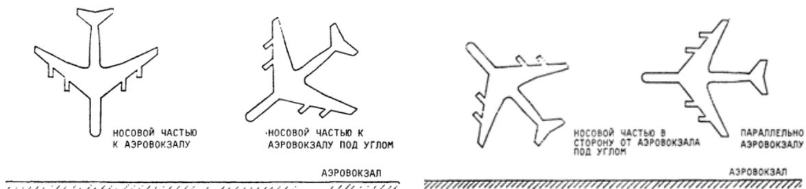
Рис. 3. Схемы расположения воздушных судов относительно здания аэровокзала
