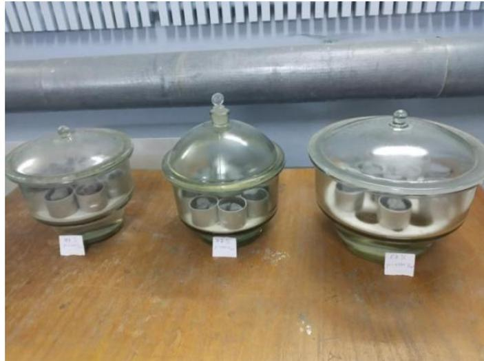
Рис. 2. Эксикаторы с образцами ячеистых бетонов
