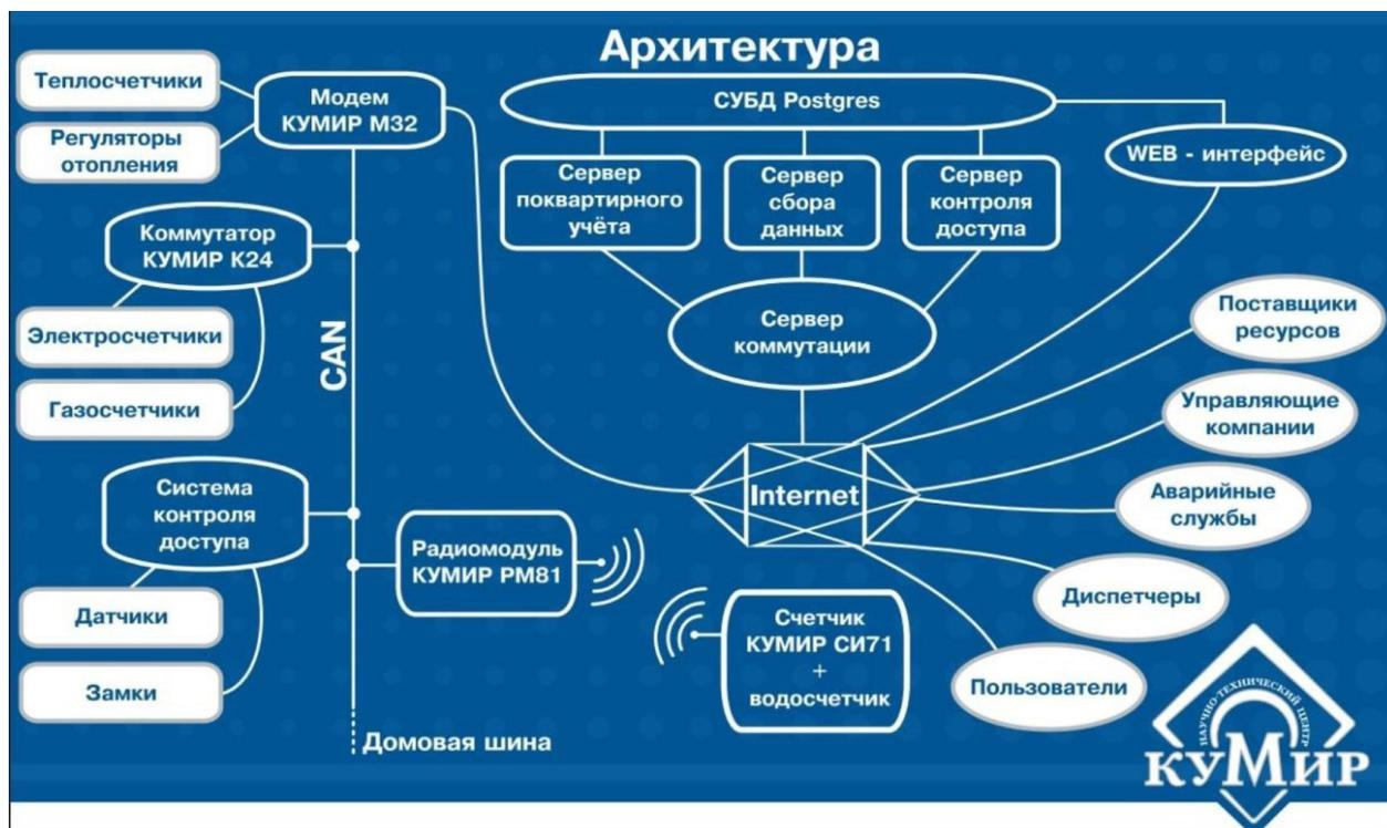
Рис. 2. Архитектура сбора данных на примере научно-технического центра «КУМИР»
