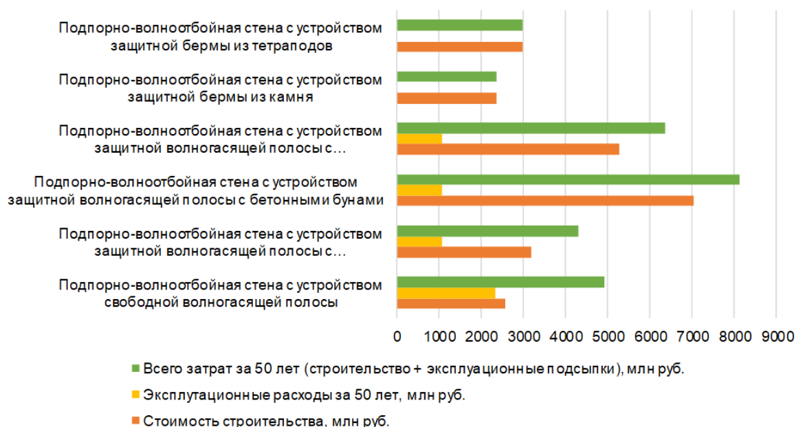
Рис. 1. Сопоставление общей стоимости (строительства и эксплуатационных подсыпок) для различных вариантов берегоукрепления Fig. 1. Comparison of the total cost (construction and operational backfills) for various shore protection structures
