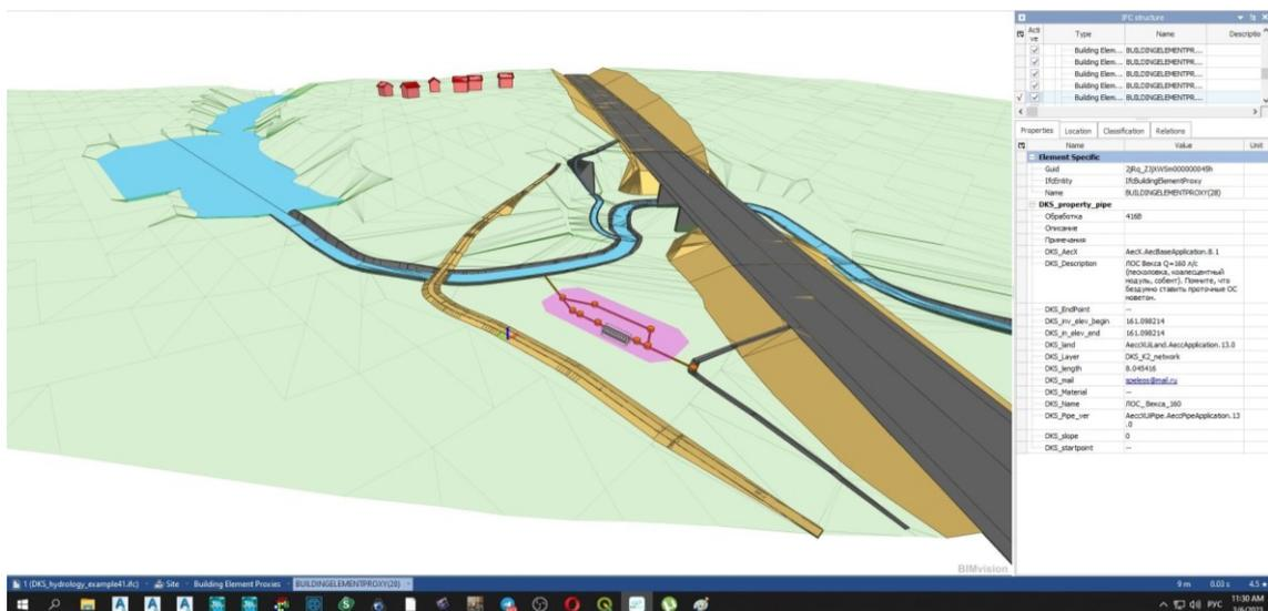
**Рис. 1. BIM-модель гидротехнического сооружения в программном продукте nanoCAD GeoniCS**
