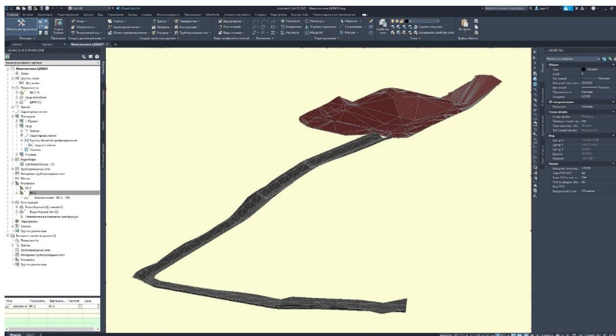
**Рис. 3. BIM-модель водосборного канала и пруда-отстойника в программном комплексе CIVIL 3D**
