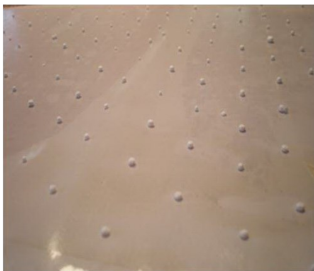
Рис. 2. Принципы построения и работы мембранного элемента с открытым каналом: a – поток концентрата в открытом канале, образованном пластиковыми шариками, приклеенными к мембране; b – фотография мембраны с приклеенными шариками
