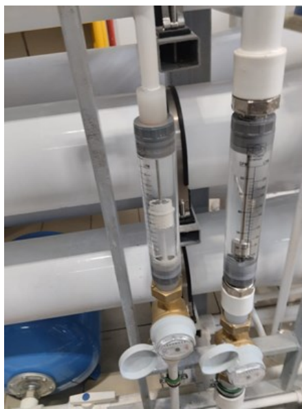
Рис. 22. Кристаллы, образовавшиеся в потоке концентрата и прилипшие к поплавку ротаметра Fig. 22. Crystals formed in the concentrate flow and stuck to the rotameter float
