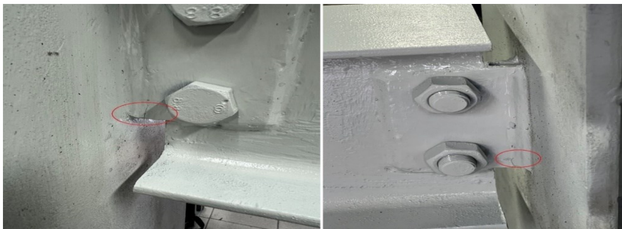
Рис. 4. Разрушения на образце с катетом шва 6 мм Fig. 4. Fracture of the specimen with a 6 mm weld leg
