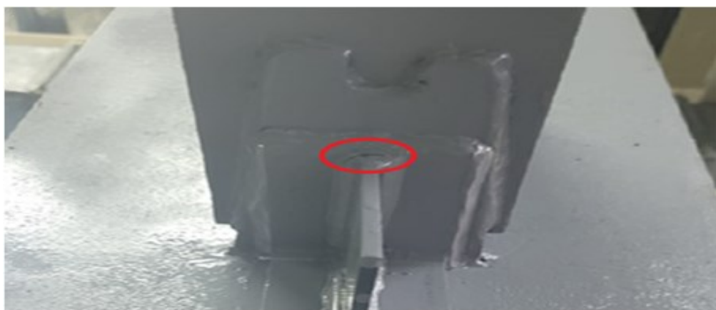
Рис. 6. Разрушения на образце с катетом шва 6 мм Fig. 6. Fractures on a sample with a 6 mm suture catheter
