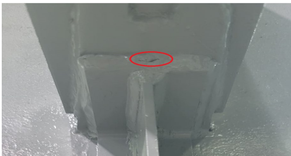
Рис. 7. Разрушения на образце с катетом шва 8 мм Fig. 7. Fractures on a sample with an 8 mm suture catheter
