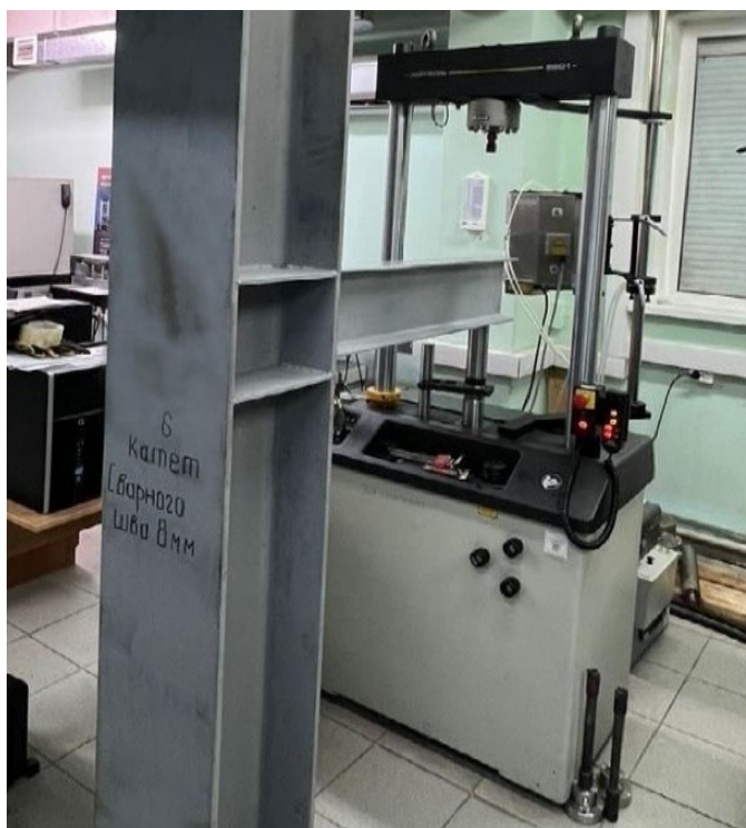
Рис. 3. Образец № 5 с катетом швом 6 мм, образец № 6 с катетом швом 8 мм Fig. 3. Sample No. 5 with a 6 mm suture catheter, sample No. 6 with an 8 mm suture catheter
