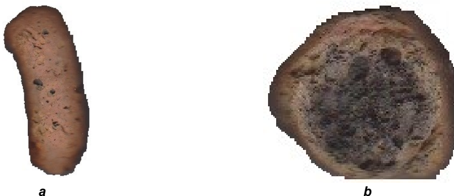
Рис. 4. Макроструктура пористого заполнителя, вид: а – внешний; б – внутренний Fig. 4. Macrostructure of porous filler, view: a – external; b – internal
