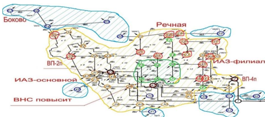
Рис. 12. Схема водопроводных сетей микрорайона Иркутск-II (зоны надежности снабжения потребителей водой)
