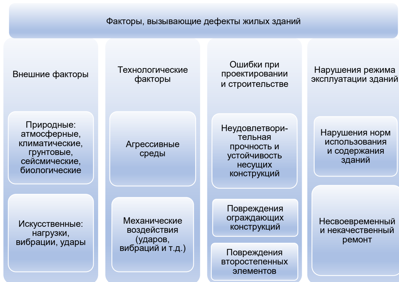
Рис. 1. Группировка факторов, приводящих к возникновению деформаций и повреждений зданий
