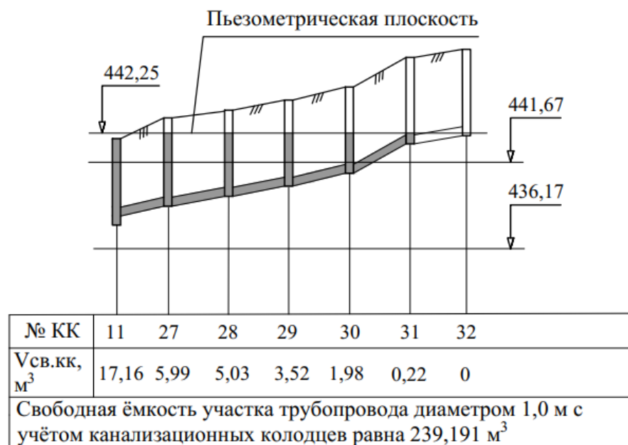
Рис. 13. Заполнение сети 11–31 колодцев Fig. 13. Filling the network of 11–31 wells
