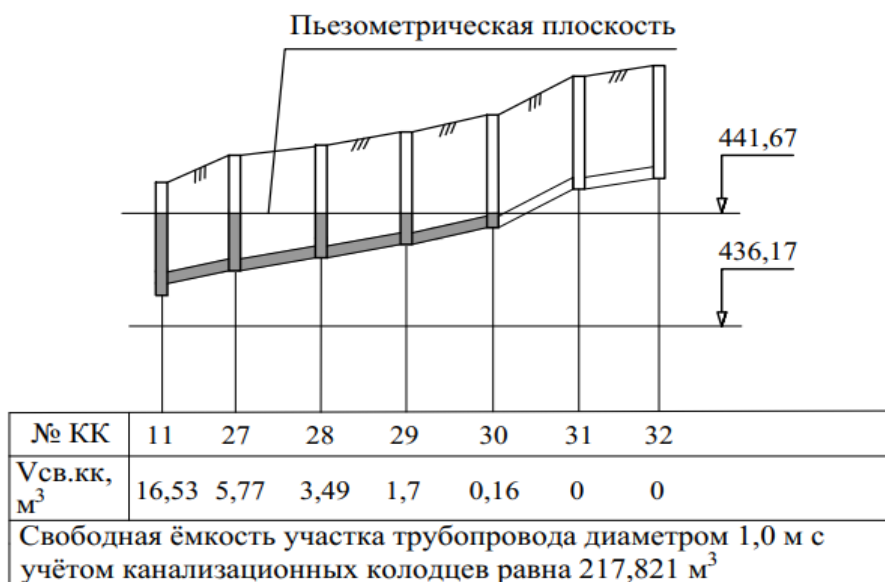
Рис. 7. Формирование аккумулярующей емкости сети (11–31 колодцы) Fig. 7. Formation of the accumulating capacity of the network (11–31 wells)
