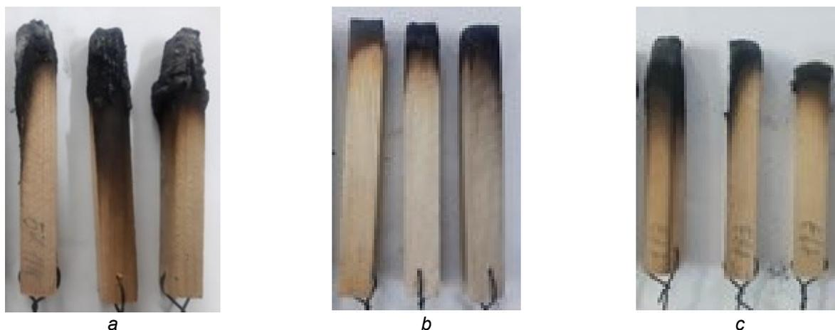
Рис. 4. Образцы, обработанные методом глубокой пропитки огнебиозащитными составами, после огневых испытаний:
