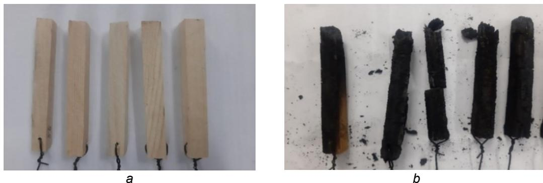
**Рис. 2.** Фотографии контрольных образцов до (а) и после (b) огневых испытаний
