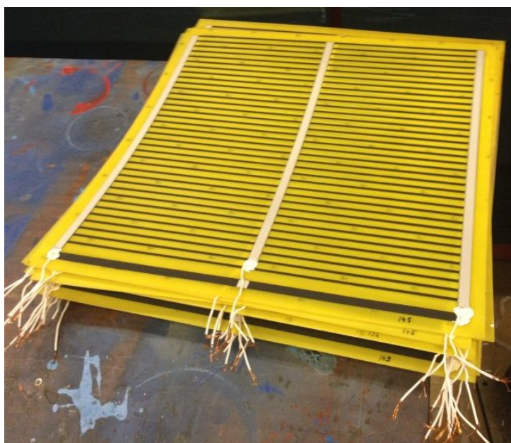
Рис. 1. Внешний вид нагревательных элементов марки НЭПС Fig. 1. Appearance of electric flat steel heater heating elements
