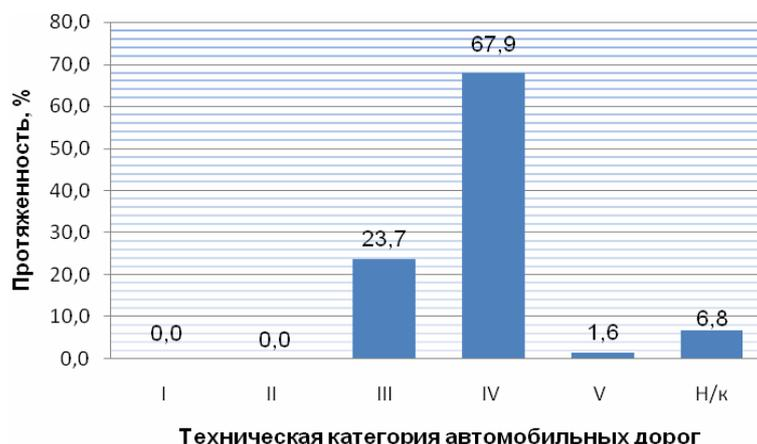
**Рис. 3.** Доля протяженности автомобильных дорог разных технических категорий Республики Бурятия
