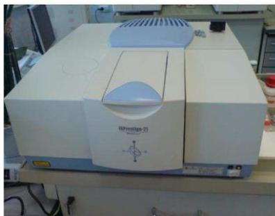
Рис. 1. ИК-спектрофотометр Shimadzu (Япония)
