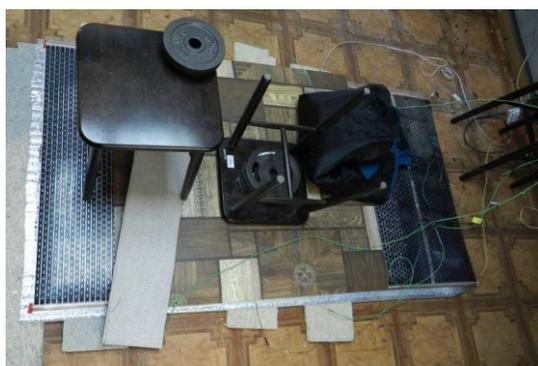
**Рис. 2.** Экспериментальный стенд для оценки надежности системы «теплый пол»
