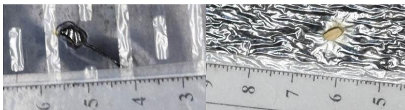
**Рис. 6.** Снимки локального расплавления ламинирующей пленки и нагревательного элемента, а также фольгированного теплоизолятора
