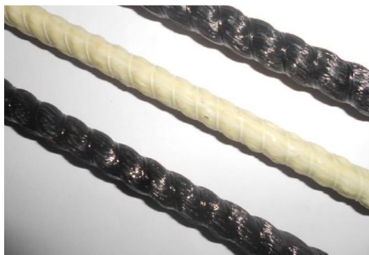
Рис. 1. Образцы стеклокомпозитной арматуры (АКС) и базальтокомпозитной арматуры (АБК) периодического профиля вида «А»
