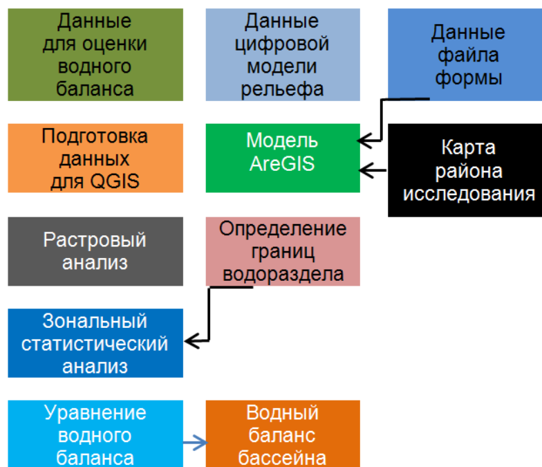
Рис. 5. Алгоритм оценки сезонного водного баланса Fig. 5. Algorithm for estimating seasonal water balance
