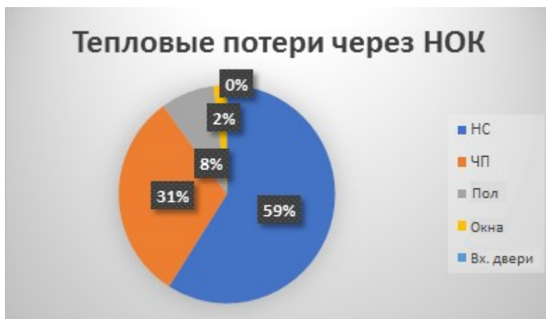
Рис. 4. Диаграмма распределения тепловых потерь по наружным ограждающим конструкциям учебного корпуса № 7.
