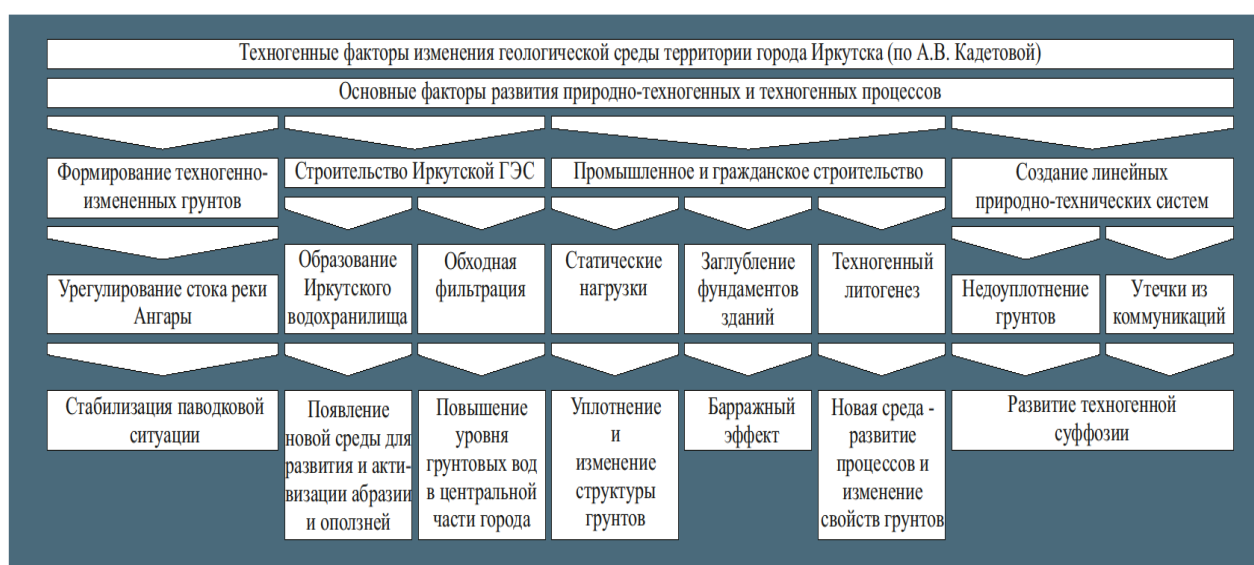
Рис. 8. Техногенные факторы изменения геологической среды территории города Иркутска (по А.В. Кадетовой) Fig. 8. Technogenic factors of changing the geological environment territory of the city of Irkutsk (according to A.V. Kadetova)
