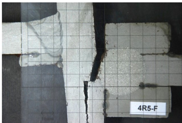
Рис. 25. Оценка сейсмического разрушения соединений ребер с помощью электрошлаковой сварки
