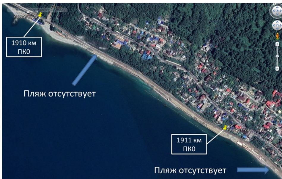
Рис. 5. Волногасящая полоса размыва на участке 2, 2019 г. Fig. 5. The wave-quenching band is blurred in section 2, 2019
