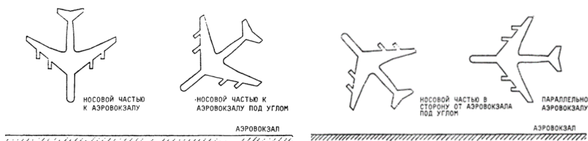
Рис. 3. Схемы расположения воздушных судов относительно здания аэровокзала Fig. 3. Aircraft location diagrams relative to the terminal building
