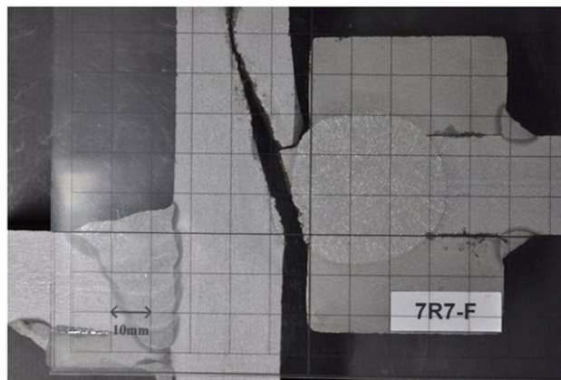
Рис. 25. Оценка сейсмического разрушения соединений ребер с помощью электрошлаковой сварки
