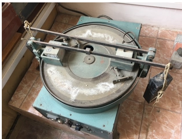
Рис. 5. Определение истираемости бетона на приборе ЛКИ-3 Fig. 5. Testing of abrasion resistance on the LKI-3
