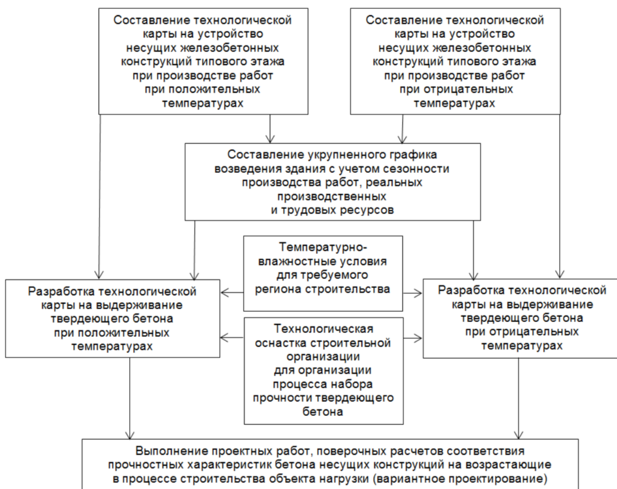
Рис. 3. Регламент (порядок) выполнения проектных работ с целью обеспечения оптимальной организации работ при возведении многоэтажного здания с несущими конструкциями из железобетона
