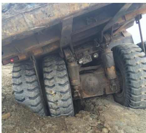
Рис. 1. Образование провалов дорог на переувлажненных грунтах Fig. 1. Pattern of the formation of road failures on waterlogged soils
