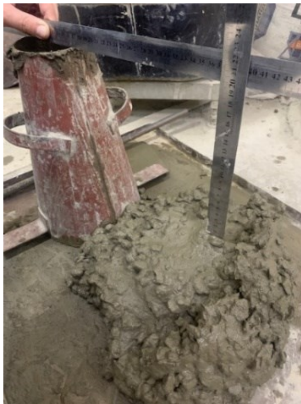
Рис. 1. Определение осадки конуса Fig. 1. Concrete slump test
