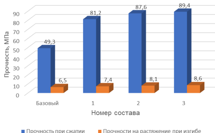
Рис. 2. Результаты определения прочности при сжатии и растяжении при изгибе Fig. 2. Compressive and tensile strength results
