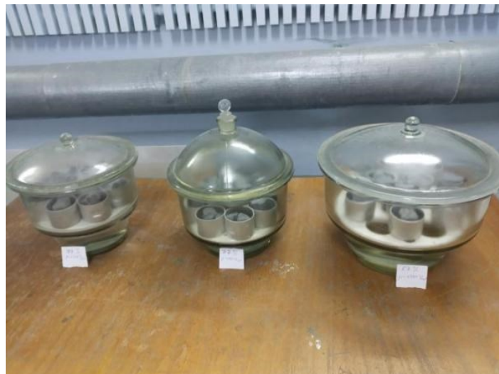
Рис. 2. Эксикаторы с образцами ячеистых бетонов Fig. 2. Desiccators with cellular concrete samples
