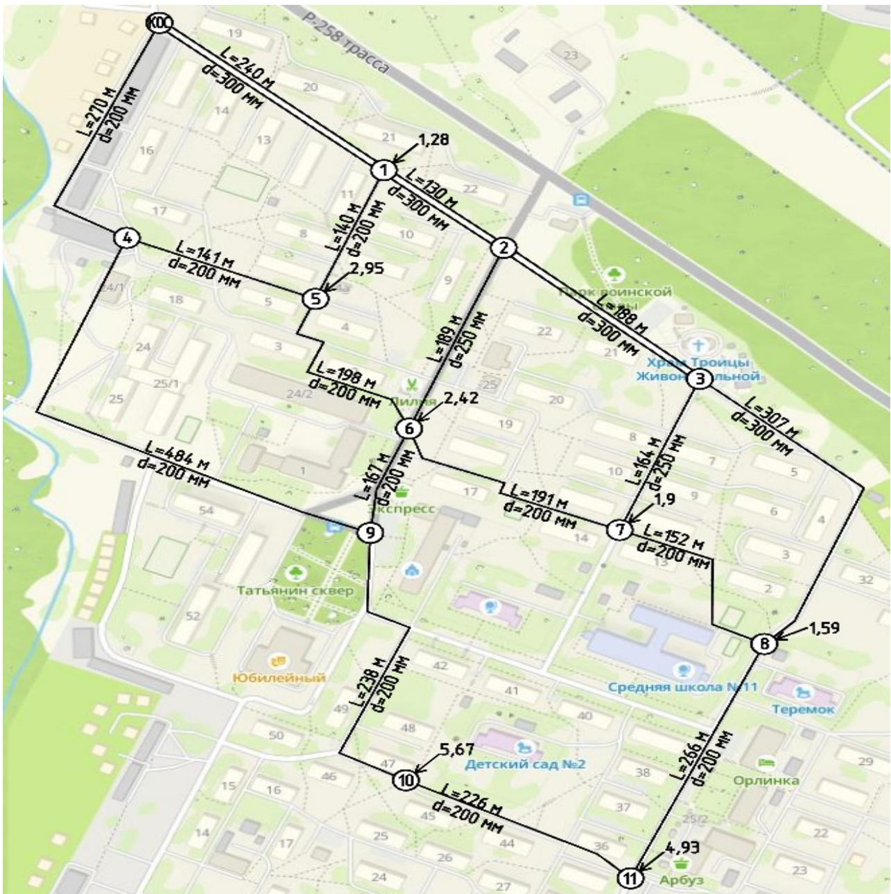
Рис. 3. Резервированная схема системы водоотведения района Южный г. Байкальск Fig. 3. Redundant scheme of the drainage system of the Yuzhny district of Baikal'sk
