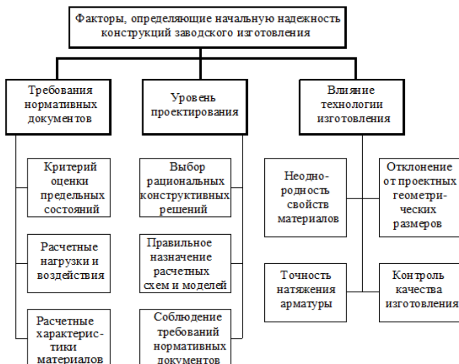
Рис. 2. Основные факторы, влияющие на начальную надежность железобетонных конструкций на стадии изготовления
