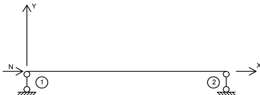
Рис. 1. Расчетная схема балки вида «шарнир – шарнир» Fig. 1. The design scheme of the beam of the "hinge - hinge" type
