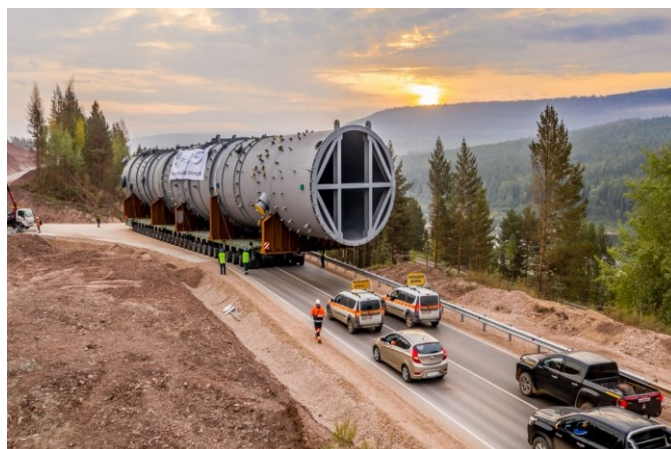
Рис. 5. Перевозка основного крупногабаритного оборудования на стройплощадку завода полимеров
