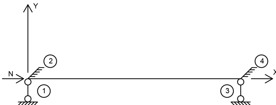
Рис. 2. Нумерации связей стержня с жесткими узлами Fig. 2. Numbering of rod connections with rigid nodes
