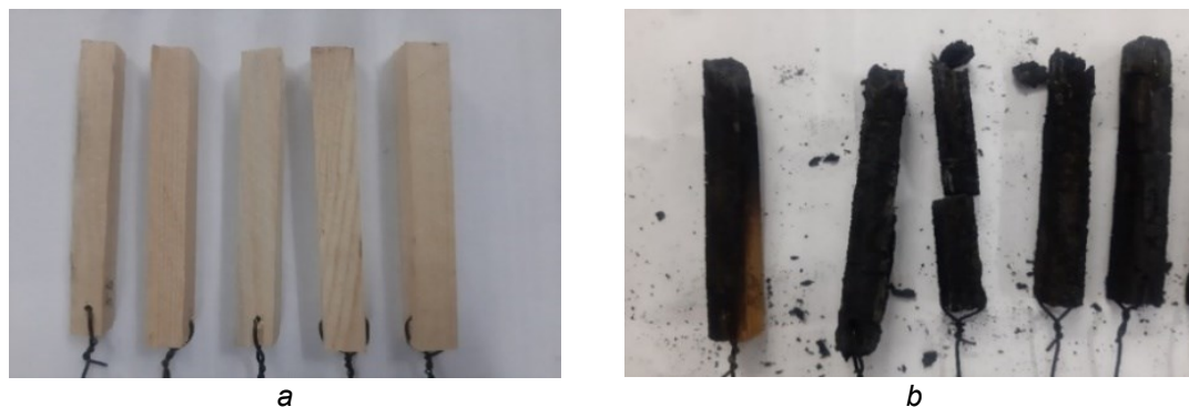
Рис. 2. Фотографии контрольных образцов до (а) и после (б) огневых испытаний Fig. 2. Photos of control samples before (a) and after (b) fire tests
